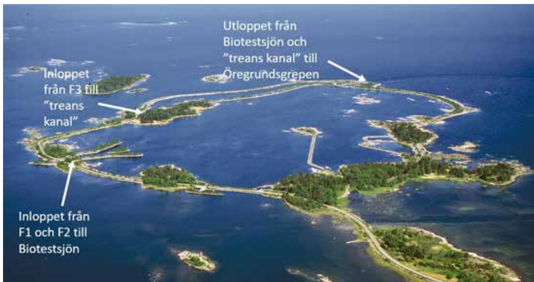
Figur 1. Biotestsjön sett från sydost. Inloppet av kylvatten från F1 och F2 till Biotestsjön syns till vänster (söder om Biotestsjön), och inloppet från F3 lite högre upp (väster om Biotestsjön). Det gemensamma utloppet till Öregrundsgrepen från de tre reaktorerna syns längst till höger i bilden (norr om Biotestsjön).
