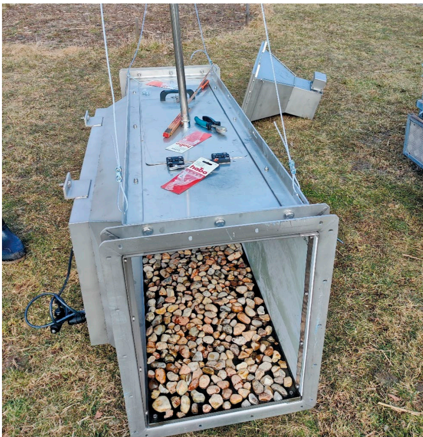
Figur 9. Tunneldelen av fiskräknaren under installation. Delar av mätutrustningen sitter i den kon som på bilden ligger snett bakom tunneln men som i färdigt skick monteras på sidan av tunneln.
