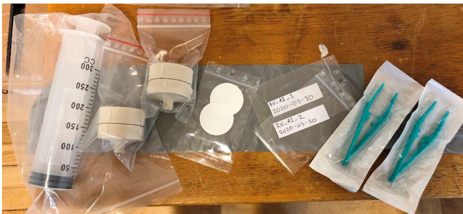
Figur B6. eDNA-provtagningskit bestående av filterhållare, filter och pincett.
