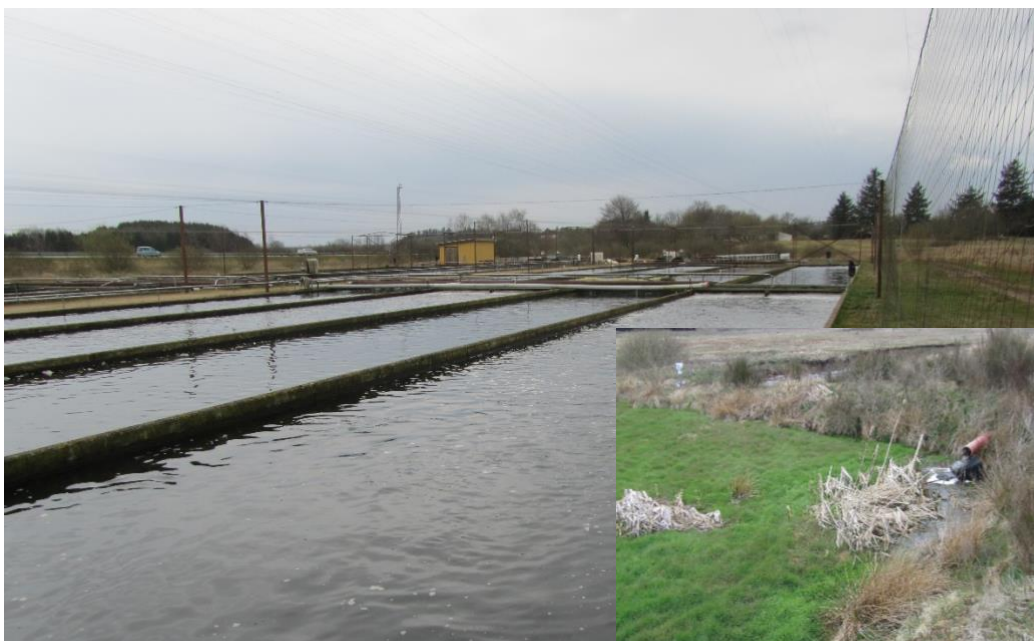
Bild 13. Ett exempel på ett danskt ”damnbruk” på Jylland, Danmark, för odling av regnbåge i dammar. Denna odling är ombyggd för att kunna återta en stor del av vattnet efter viss rening av vattnet, medan utsläppt vatten först går igenom en anlagd våtmark infällda bilden) innan det återförs till recipienten i form av en bäck eller å (syns i bakgrunden på infällda bilden).
