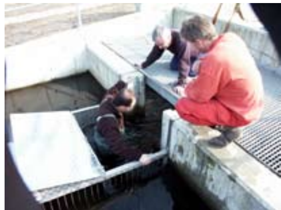
Figur 27. Björn Tengelin, Egon Sjödin och Erik Sjölander sätter en fiskfälla på plats i utskovet på omlöpet i Svartån, Örebro (jämför Figur 7). Initialt användes ett gles metallgaller för att kontrollera passage av större fisk (se bilden), därefter monterades ett finmaskigt plastnät utanpå fällan för att fånga alla migrerande fiskar under några nätter. Försöket genomfördes i slutet av april-början av maj 2002. Nattetid migrerade tusentals benlöjor tillsammans med hundratals abborrar, mörtar, gäddor, färor, björknor och braxar. Omlöpet fungerar således mycket bra.
