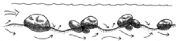
Figur 12. Tänk på att placera ståndsten och strukturer så att botten, den hyporheiska zonen, får ned- och uppträngande vatten. Förankra storstenen ned ca 1/3 i botten och vänd generellt, inte alltid, den smala sidan mot strömmen.
