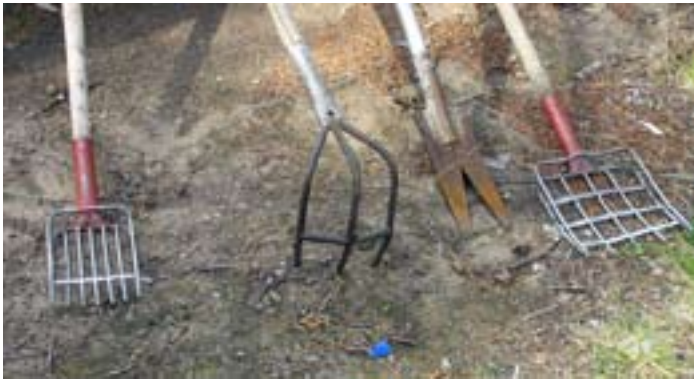
Figur 2. Fyra specialutvecklade redskap för Hartijokki-metoden vid etablering av lekbottenar för öring. Med de två mittersta redskapen (kratta resp spett) luckras botten upp och större sten och block flyttas. Det högra redskapet (sikten) används sedan för att ta bort mindre sten som anses för stora (>5 cm) som leksubstrat. Det vänstra redskapet (skyffel) används för att sälla ut och flytta lämpligt lekmaterial. Detta flyttas till den nya lekbotten. Redskapen kan man tillverka själv eller beställa på hemsidan för Nilivaara sportfiskeklubb ( www.kalixriver.se/inter/nilivaara/ ).
