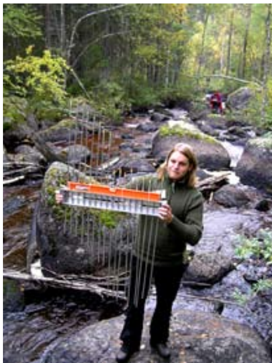
Figur 1. Johnny Norrgård, länsstyrelsen i Jönköping, provar ett instrument som mäter bottenstrukturen/vattendjupet på ett standardiserat sätt. Ramen trycks ned i botten och sedan avläses djupförhållandet på respektive stav. Detta ger ett mått på bottenens habitatdiversitet.
