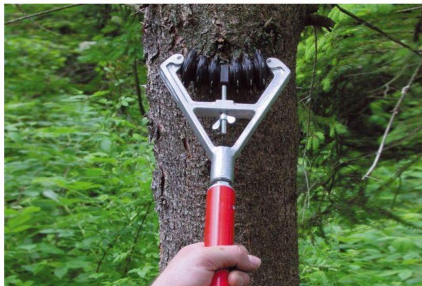
Redskap som används till att ritsa barken. Barken skyddas av kåda och av att barken i sig blir hård och skrovlig.
