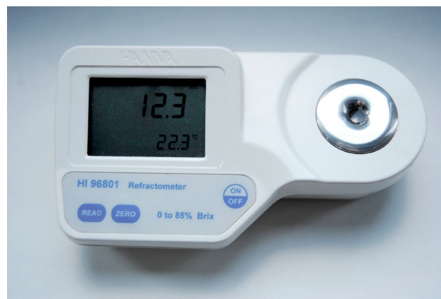
Figur 3. Digital refraktometer för analys av total löslig torrsubstans (Brix). Foto: K. Rumpunen.
