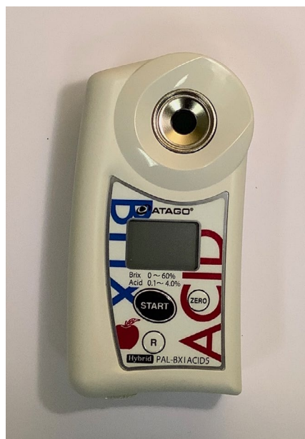
Figur 6. En kombinationsmätare för analys av total löslig torrsubstans (Brix) och total syrahalt (angivet som äppelsyra), som också beräknar förhållandet dem emellan. Foto: K. Rumpunen.
