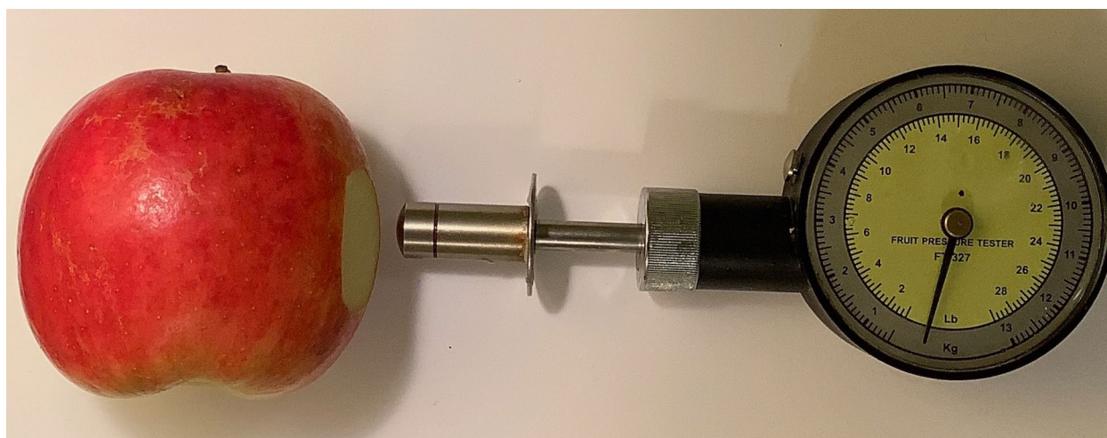
Figur 1. Fasthetsbestämning med manuell penetrometer. Foto: K. Rumpunen
