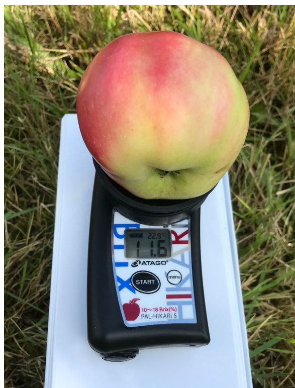
Figur 4. Icke-destruktiv IR-mätare för analys av total löslig torrsubstans (Brix). Foto: K. Rumpunen
