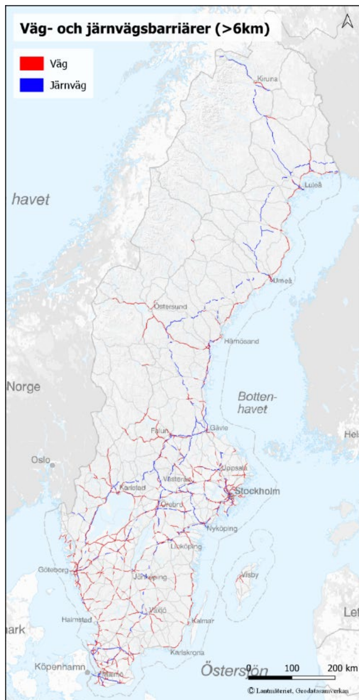
Bild 2. Barriärsträckor med återstående behov av säkra passagemöjligheter för större däggdjur, enligt kriterier i Trafikverkets styrdokument Riktlinje landskap (Trafikverket 2019a). Illustration: Emma Håkansson /EnviroPlanning AB
