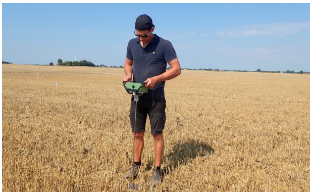
Penetromettermätning i augusti 2020 i Kornheddinge utanför Stafanstorps. Penetrometern mäter det vertikala motståndet i marken, men resultaten visade inte några statistiskt säkra skillnader mellan strukturkalkad och okalkad mark. Foto: Jens Blomquist.
