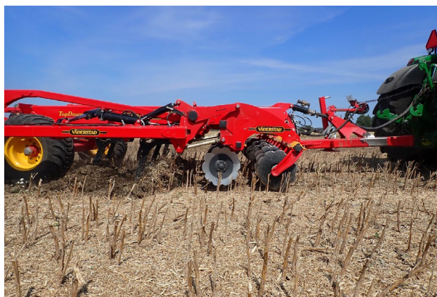
Bearbetningsdjupet ställdes in på 12 cm i samtliga försök och körhastigheten var 8 km/h. Tallriksredskapet i fronten lyftes upp så att bara pinnar och spetsar bearbetade jorden. Återpackarvälten bakom kultivatorn hölls flytande med sin egen vikt, men utan att jorden packades. Foto: Jens Blomquist.
