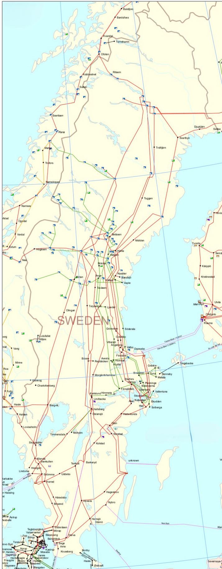
Bild 4. Högspänningsledningar i transmissionsnätet samt utlandsförbindelser. Ledningar i rött = 400 kV växelström, grönt = 220 kV växelström, lila = högspänning likström. Kartan visar även större elproducenter som rektanglar (vattenkraftverk, vindparker, kärnkraftverk, kraftvärmeverk). Karta © ENTSO-E 2023.
