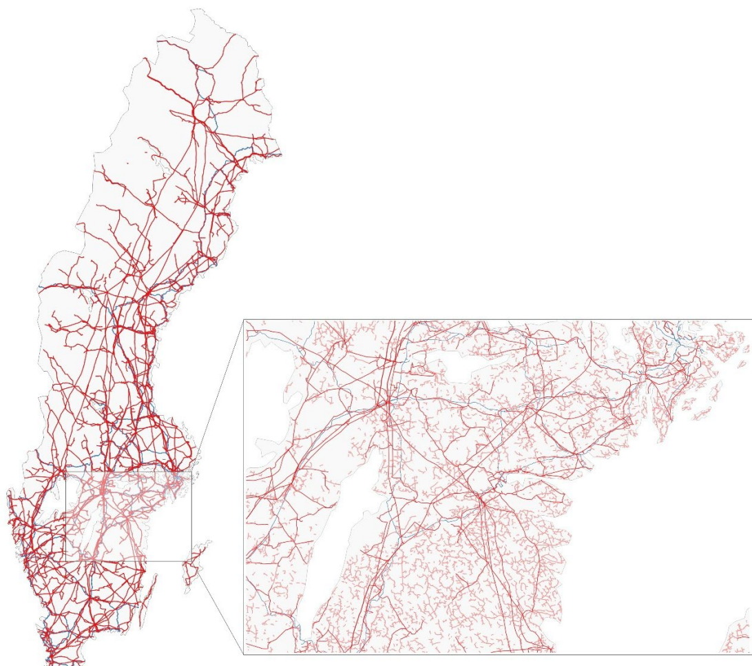
Bild 2. Luftledningsnätet; Sverigekartan visar transmissions- och regionnät i rött samt järnvägsledningar i blått, detaljbilden visar förutom transmissions- och regionnät i rött även lokalnät i ljusare röd nyans. Data från Lantmäteriet (Topografi 10) samt Trafikverket (NJDB), nedladdade sep 2023; illustration SLU Centrum för biologisk mångfald.
