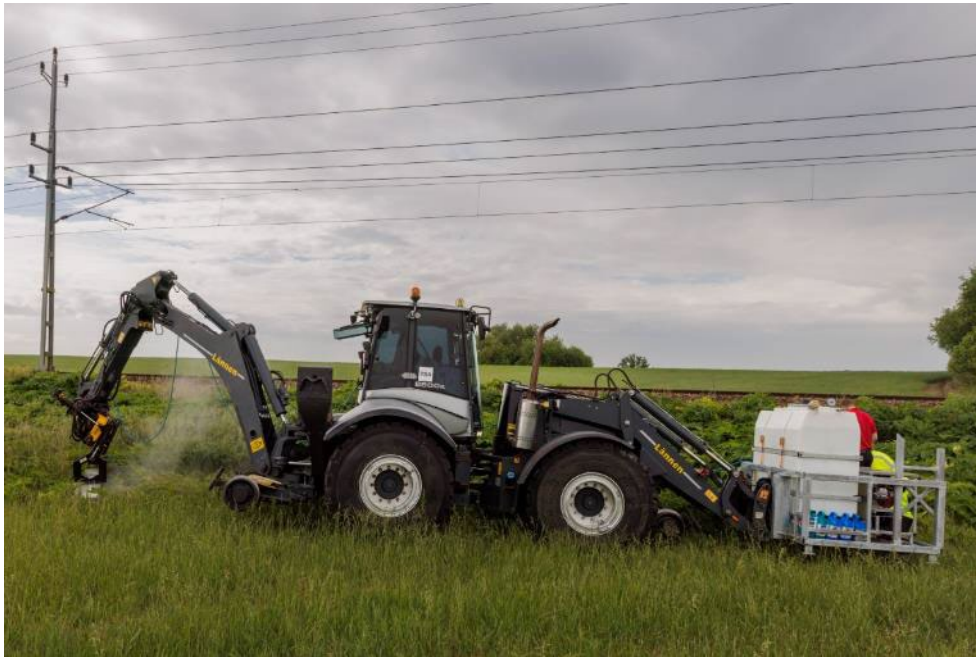
Figur 19. Traktorgrävare med vattenbehållare och värmeaggregat monterad i fronten och med en bekämpningsramp som vattenförsörjs via en slang monterad på den bakre armen. Foto: Harald Cederlund.
