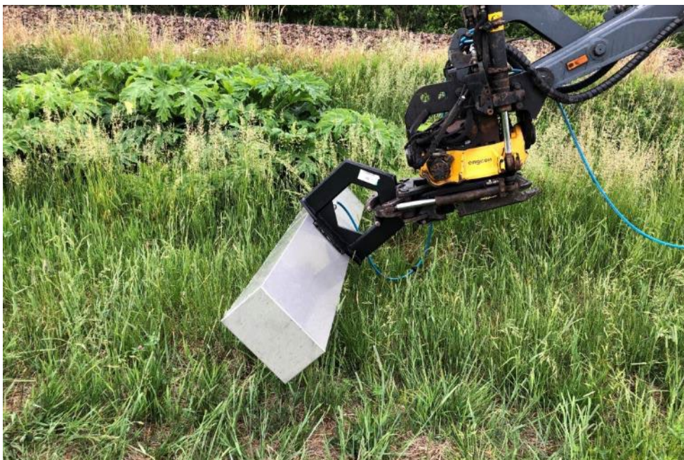
Figur 20. Bekämpningsrampen i form av en ca 2,5 m bred metallåda som invändigt har ett rör försett med munstycken. Foto: Fredrik Fogelberg.
