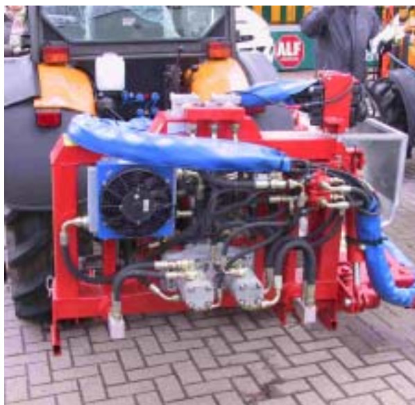
Figur 4. T.v.: Fräsen Krümler (Ladurner) har två fräshuvud. En av dem går längs gräsbanans kant, medan den andra arbetar in och ut mellan träden (Foto: Malin Engström). T.h.: Fräsen har ett eget, avancerat hydraulsystem vilket gör att inköpspriset blir relativt högt (Foto: David Hansson).
