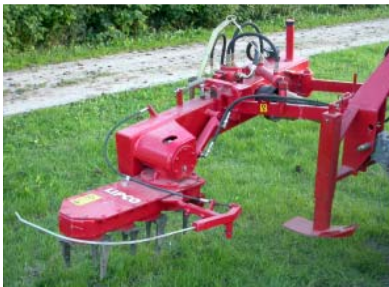
Figur 6. Fräsen från företaget Lipco GmbH behöver något bättre förutsättningar (stenfri jord, lägre ogräsnivå), än t.ex. fräsen Ladurner, för att ge ett bra resultat (Foto: Johan Ascard).
