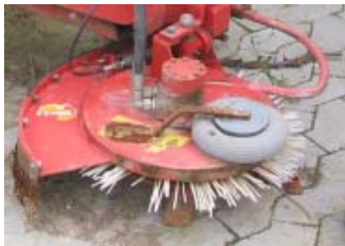
Figur 7. Fräsen Humus Planet har ett roterande fräshuvud och styrs med aktiv sidoförskjutning (Foto: Malin Engström).
