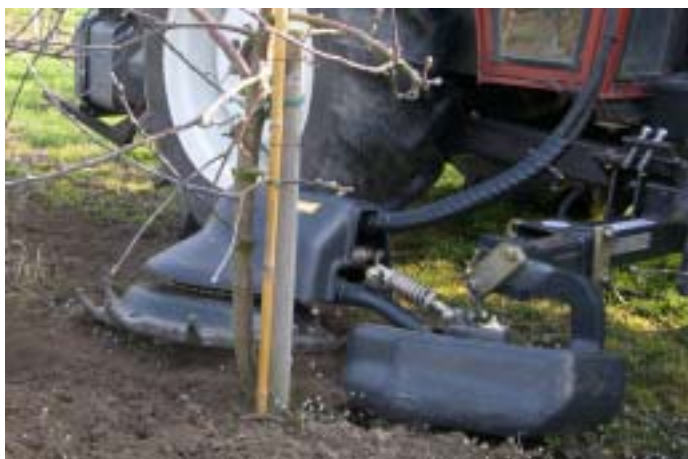
Figur 8. T.v. en sidomonterad fräs från Pellenc, modell Tournesol (Foto: David Hansson). T.h. en illustration av fräsens arbetsmönster (Teckning: Johan Nilsson).
