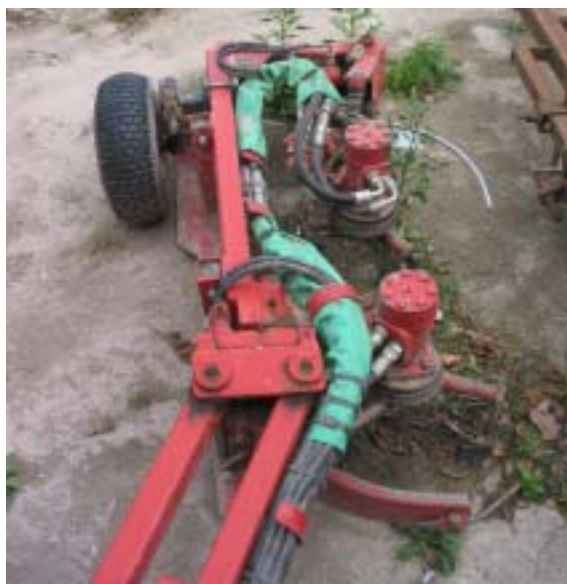
Figur 4. T.v.: Fräsen Krümler (Ladurner) har två fräshuvud. En av dem går längs gräsbanans kant, medan den andra arbetar in och ut mellan träden (Foto: Malin Engström). T.h.: Fräsen har ett eget, avancerat hydraulsystem vilket gör att inköpspriset blir relativt högt (Foto: David Hansson).
