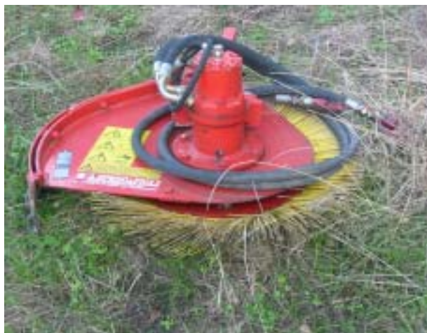
Figur 5. Fräs med borstaggregat från företaget A. Spedo & Figli. Redskapet används tillsammans med ett drivaggregat som har aktiv funktion för sidoförskjutning (Foto: Malin Engström).
