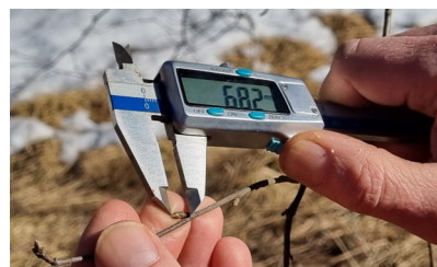
Figur 2. Knopplängderna mäts med skjutmått. Foto: Ola Langvall.
