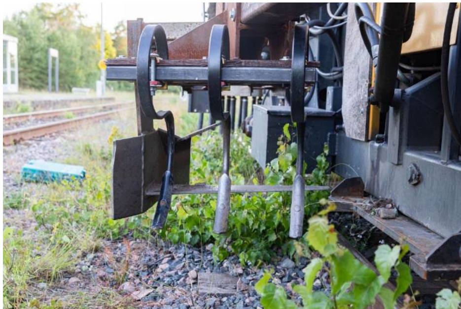
Figur 7. Vingskär med tre harvpinnar monterade framför – den yttre harvpinnen plockades snart bort då uppräckta växter fastnade. Foto: Harald Cederlund.
