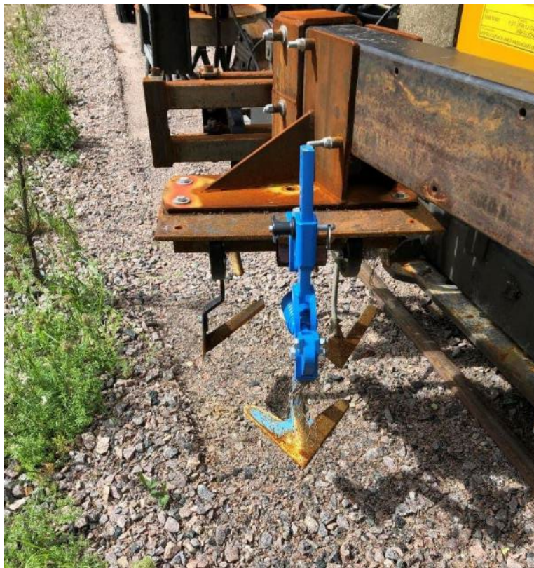
Figur 6. En uppsättning av de provade hackskären som testades i de första försöken. Foto: Fredrik Fogelberg.
