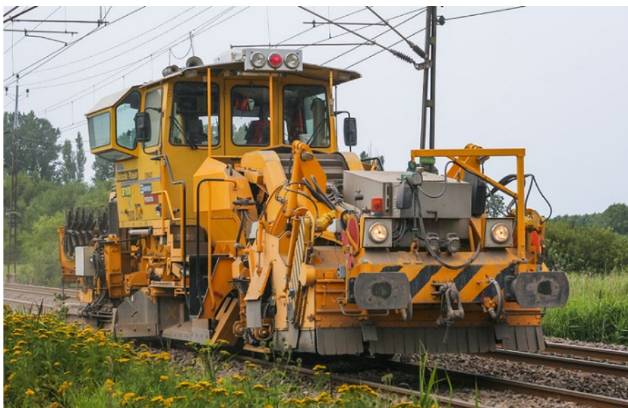
Figur 31. Exempel på ballastplog som används i Sverige. Foto: Frederik Tellerup från hemsidan jarnvag.net .
