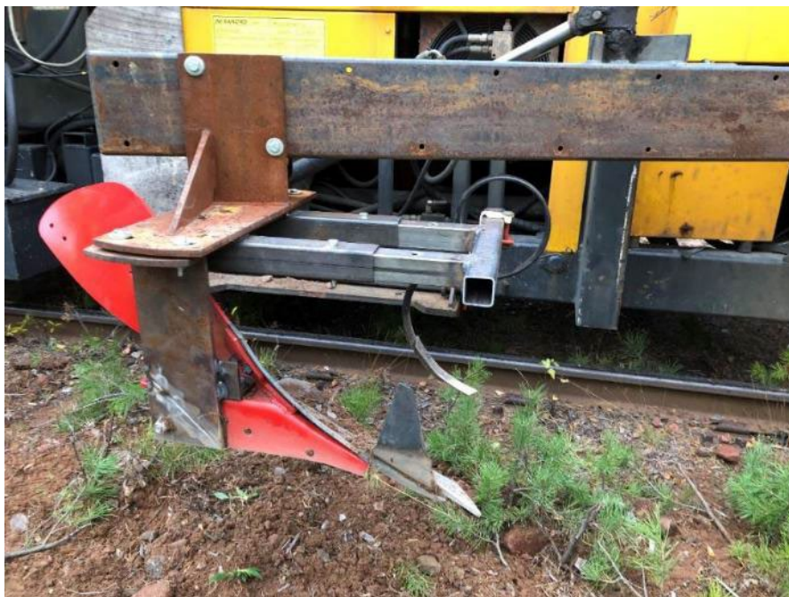
Figur 33. Vid mycket kraftig vegetation och behov att skapa (återskapa) diken kan en kombination av lantbruksplog och skrapning användas. Foto: Fredrik Fogelberg.
