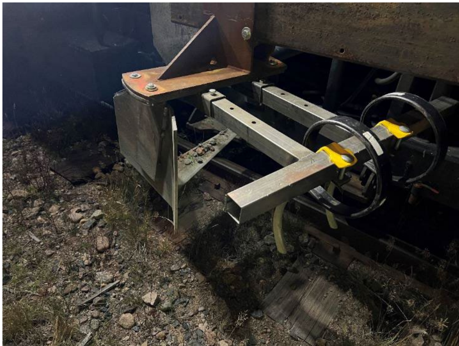
Figur 9. Förbättrad konstruktion efter ett antal iterationer. Harvpinnar främst som drar upp ogräsen monterade på justerbart avstånd från ett vingformat skär som klipper av ogräs under
