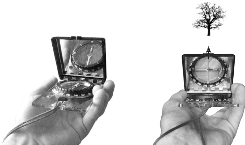
Figur B1. Eftersom transekterna alltid ligger i rak nord-sydlig eller öst-västlig riktning kan kompassen alltid ställas in på 360 eller 90 grader. Håll kompassen plant, se till att kompassnålen ligger rätt och ta sikte på ett terrängföremål.
