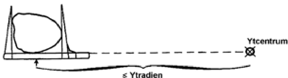
Figur 8.1. Klavning ska ske i brösthöjd (dvs. på 1,3 meters höjd) över trädets gröningspunkt med klavens linjal riktad mot provytacentrum. Klavningen görs på träd vars gröningspunkt ligger inom ytans radie.
