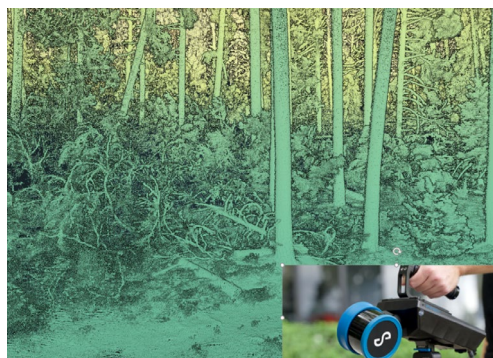
Figur 14. Mobil laserskanning från ett område vid Sörmlandsleden med mycket liggande träd. Den handhållna Hovermap laserutrustningen som använts syns i nedre högra hörnet. Den blå skannerdelen i utrustningen är av samma typ som använts för drönarskanningen i figur 11. Data insamlat av AMKVO för Sveaskog.
