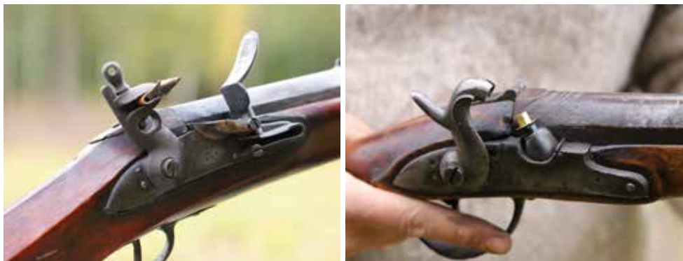
Ryskt flintlås (t.v.) från 1836 som återanvänts i en sälbössa från Roslagen. Flintlåset var känsligt för fukt och krävde noggsamt underhåll för att fungera. I hanen sitter flintan och här är eldstålet uppfällt och blottar fångpannen. Slaglås (t.h.) i uppspant läge med en knallhatt på knallhattstapp. Låset är konverterat från flintlås vilket var ett mycket vanligt och enkelt sätt att modernisera äldre vapen på Swederus tid. Foto: Lars Arvidsson.
