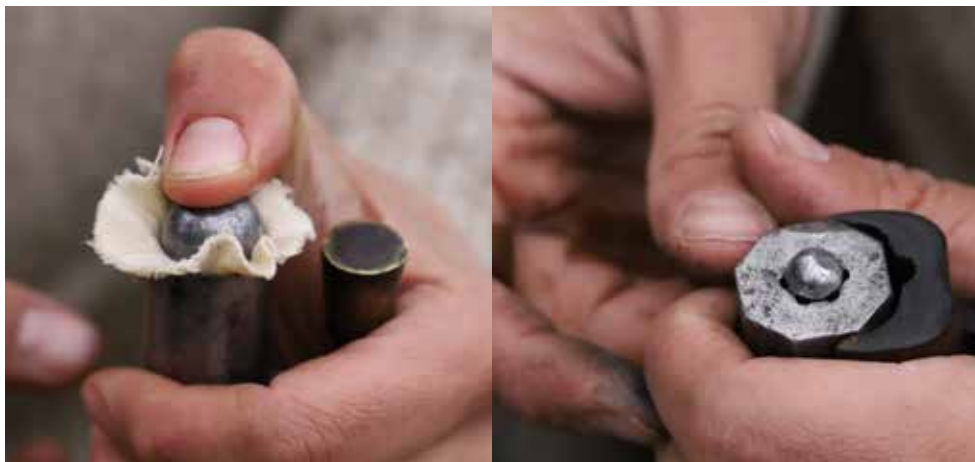
Kula med fetlapp (t.v.). När jägaren laddade en studsare omslöt man kulan med en infettad lapp i skinn eller tyg. Detta gjordes för att täta utrymmet mellan kulan och loppets räfflor. Lodbössa med trångkula (t.h.). På räfflade vapen med liten kaliber användes en kula som var något större än loppet, så kallad trångkula. Kulan stöttes ner i loppet och kulan formades efter loppets räfflor. Foto: Lars Arvidsson.
