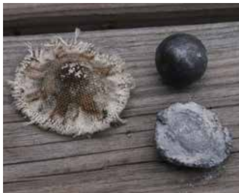
Rundkula, skjuten fettlapp och tillplattad kula. En återfunnen fettlapp var en viktig indikator för att kunna bedöma loppets skick och om laddningen var lämplig. Foto: Lars Arvidsson.
