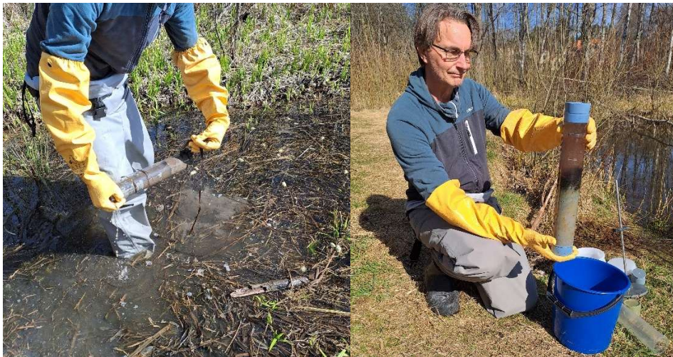
Figur 1. Fotografier över bottenmaterialinsamling med Willnerhämtnare i Skönstaholmsdammen (S). Den undre fraktionen i rörhämtnaren hälldes bort och det övre lagret (ca 5 cm) samlades in.
