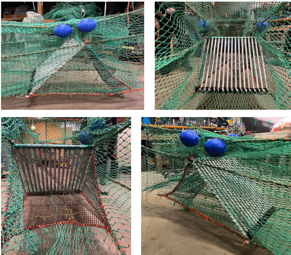
Figur 1. Bilder på den fristående storleksselekerande risten som sitter monterad bakom standardristen. Det är öppet bakom risten och all fångst som går igenom risten släpps ut. Bilder: Henrik Torkelsson.
