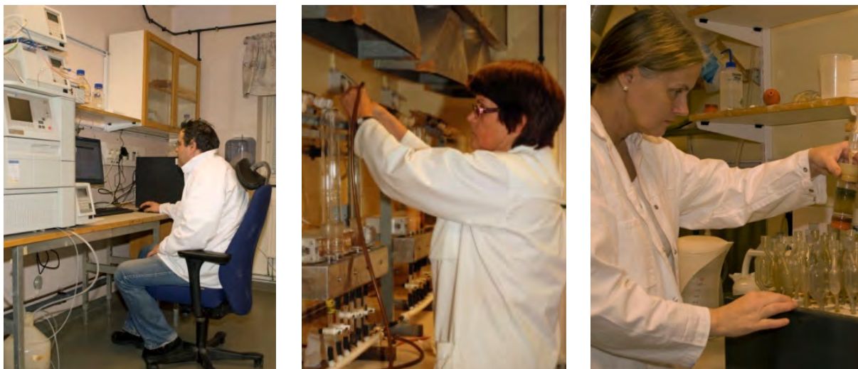
Figur 18. Några bilder från analysverksamheten vid laboratoriet, Kungsängens forskningscentrum. Från vänster till höger; analys av flyktiga fettsyror med HPLC-teknik, växttrådbestämning samt VOS-analys, som fått stor betydelse vid bestämning av energivärdet i vallfoder (Foto: Bengt Everitt).
