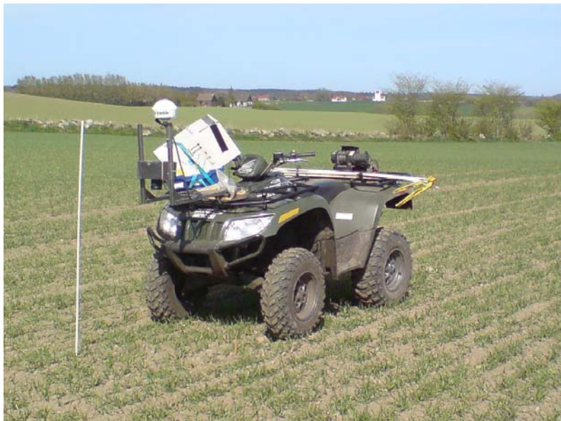
Figur 2. Kamera, GPS-mottagare och dator monterat på fyrhjulig motorcykel. De ytor där ogräset skulle räknas manuellt markerades för att få bildanalys och manuell räkning på samma yta.
