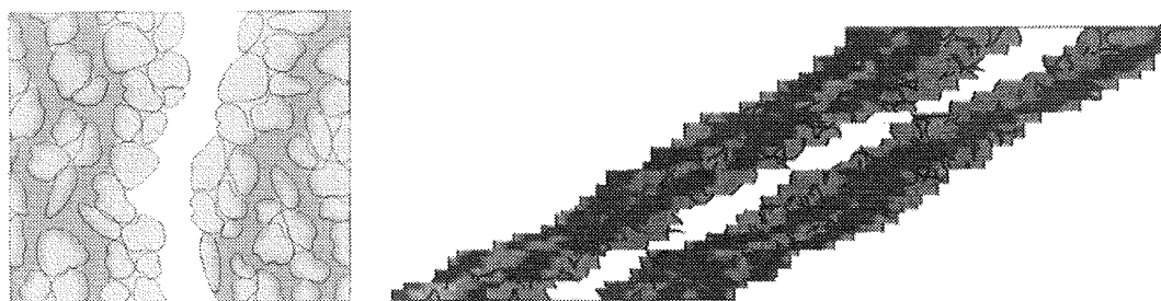
Figur 6. Parallellförflyttning av partiklar runt por på grund av skjuvning (Horn, 2001).
