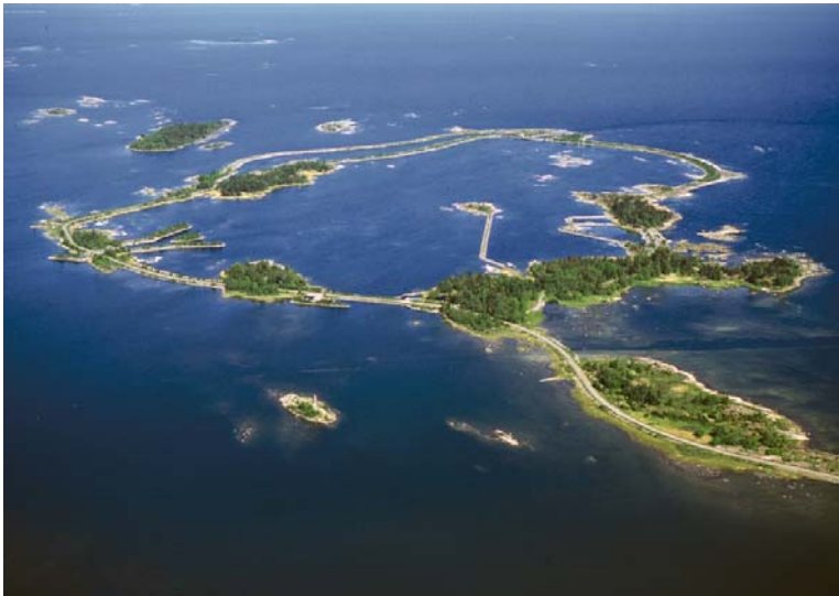
Figur 1.2. Biotestsjön sett söderifrån. Inloppet av kylvatten till anläggningen syns till vänster och utloppet till Öregrundsgrepen längst upp i bilden. Lagunen ligger till höger.
