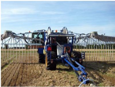
Figur 2c. SDS-spridaren är utrustad med två horisontellt monterade armar och släpslangar med en diameter på \varnothing 45 mm. Det är möjligt välja mellan en 24, 30 eller 36 meters ramp. Slangtrumman är försedd med en 650 meter lång slang av slitstark plast. Detta gör att man kan täcka upp till 40 hektar i en uppställning. Biogödsel sprids både vid körning fram och tillbaka längs körspåret. Vid backning, vrids hytten 180 grader, vilket ger föraren full utsikt över hela arbetsoperationen.
