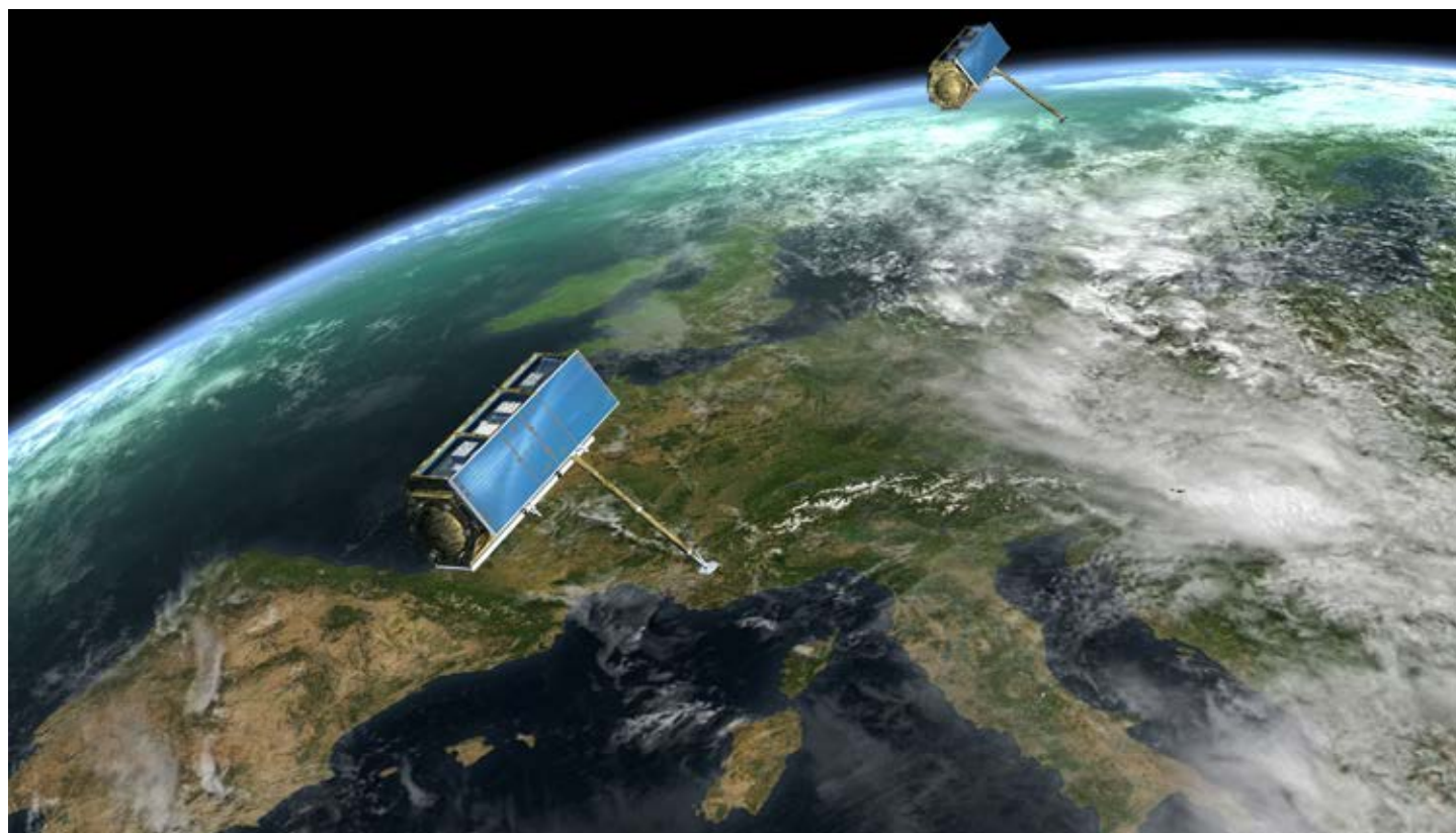
Figur 1. De tyska satelliterna TerraSAR-X och TanDEM-X som flyger i formation i omloppsbanan runt jordklotet mäter noggrant markens och vegetationens höjd med så kallad interferometrisk radarteknik. (Bild från Tyska Rymdstyrelsen, DLR.)
