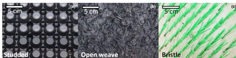
Figur 37. Olika substrat testade för funktion i ålyngelledare a) plastsubstrat med förhöjda rundade former respektive små fördjupningar b) Enkamat c) borst. Källa Tidskrift Animal Conservation artikel Watz m. fl. 2019.
