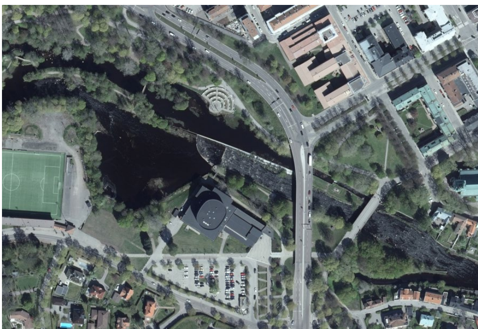
Figur 28. Fiskpassage i form av ramp/upptröskling inom vattendraget där utrymmet är begränsat. Här vid konserthuset i Gävle. Foto: Mattias Olsson, Länsstyrelsen Västernorrland.
