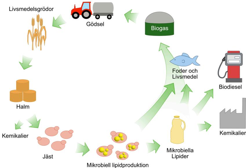
*Figur 1.* Hållbar mikrobiell lipidproduktion för bränslen, kemikalier eller livsmedels- och foderproduktion i ett cirkulärt bioraffinaderi. Därför används vete-halm som substrat för mikrobiell lipidproduktion med jäst som produktionsorganism. Ytterligare användningen av resterna för biogas och återcirkulation av dem som gödselmedel stänger cirkeln för ny livsmedelsproduktion.
