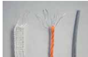
Bild 17. Olika typer av elband/lepp är olämpliga att använda i permanenta stängsel. Jämför de tunna ledarna i plastbanden med 2,5 mm HT-tråd (till höger).
