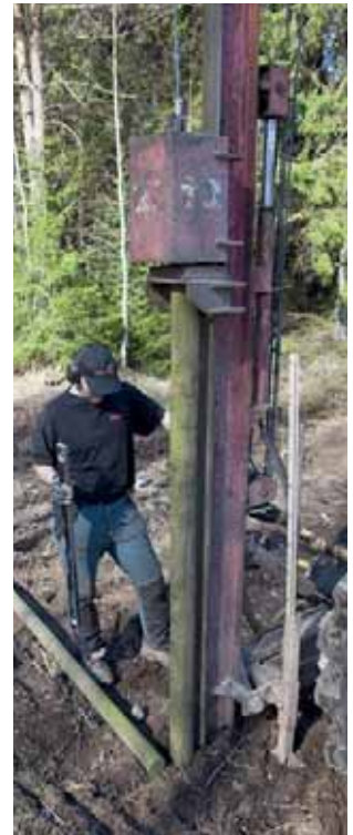
Bild 16. Stolpnedslagare som monteras på traktorn.
