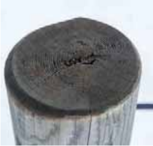
Bild 13. Välj hållbara stolpar. Ju tätare årsringar desto längre livslängd.
