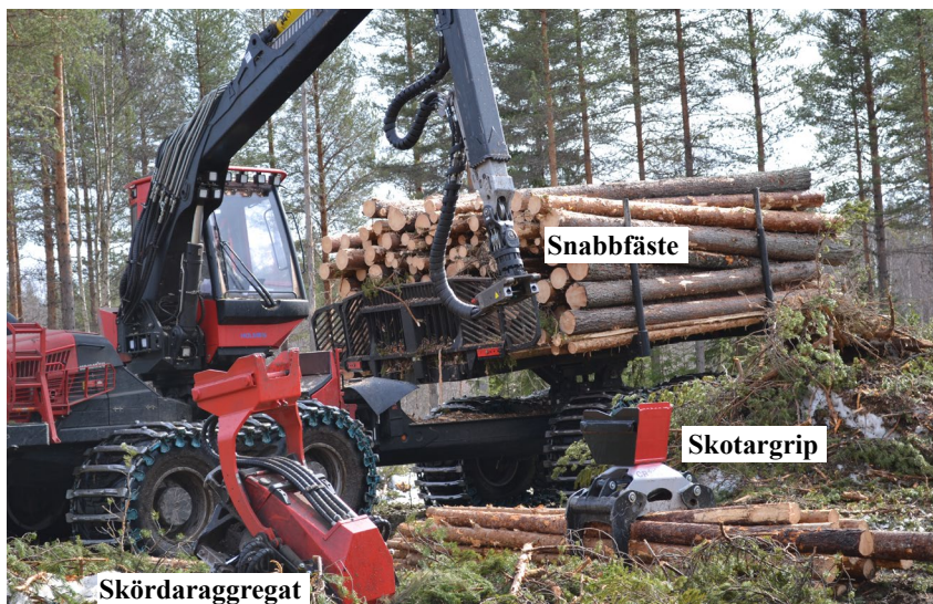
Figur 5. Konzeptdrivaren Komatsu X19 med snabbfäste, här i samband med skifte mellan skördaraggregat och skotargrip. Skotargripen underlättar lossning, och skördaraggregatet möjliggör avverkning. Drivaren är ett exempel på ett enmaskinsystem som kan vara lämpligt för hyggesfritt skogsbruk. Foto: Rikard Lundqvist.
