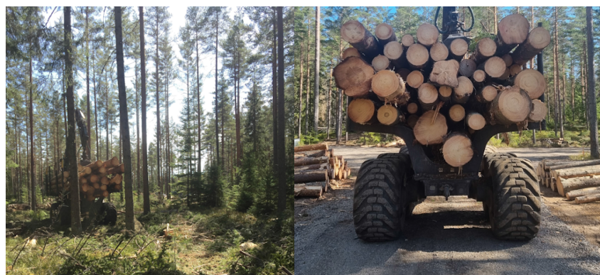
Figur 2. Skotaren är en liten John Deere 1110G (lastkapacitet 12 ton). Foto: Max Hedlund (vänster) och Anton Jernberg (höger).
