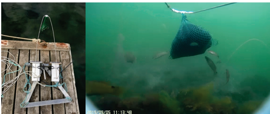
Figur 2. Ställning med två undervattenshus, ett som innehöll kamera och ett som innehöll lampa, samt ställning med betespåse (vänster). Stillbild från film av betespåse med skuren sill (höger).
